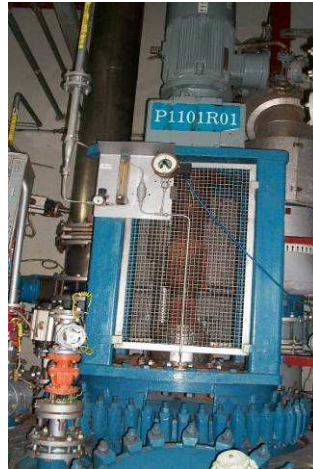
拉斯卡工程设计安装的气相润滑机械密封的监控装置
